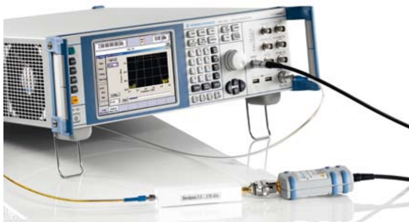
Скалярный анализ внешнего полосового фильтра (с опцией для анализа мощности R&S®SMF-K28 и датчиком мощности R&S®NRP-Zx).
