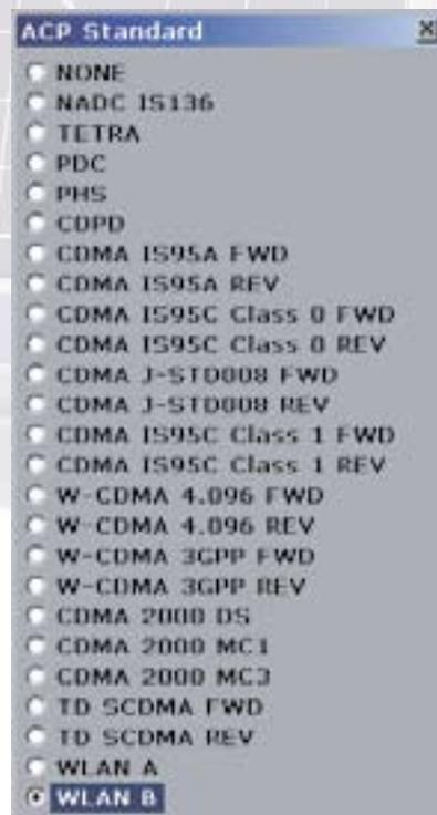
Широкий набор функций R&S®FSL включает измерение мощности в текущем/соседнем канале. Для упрощения работы многие стандартные настройки можно выбирать простым нажатием кнопки
