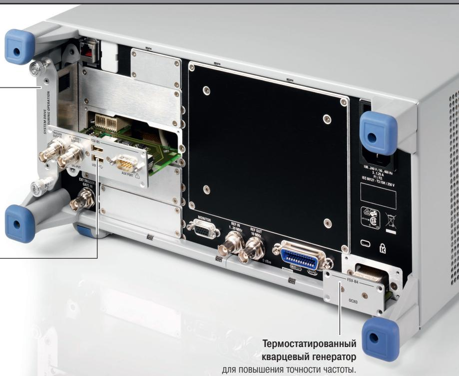
Термостатированный кварцевый генератор для повышения точности частоты.
