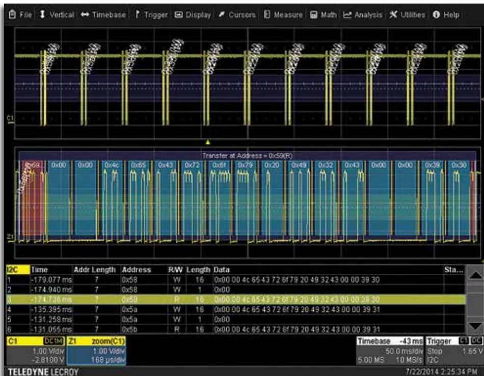
Информация о декодировании с наложением на физический уровень анализируемого протокола отображается в Таблице, расположенной ниже входного сигнала
