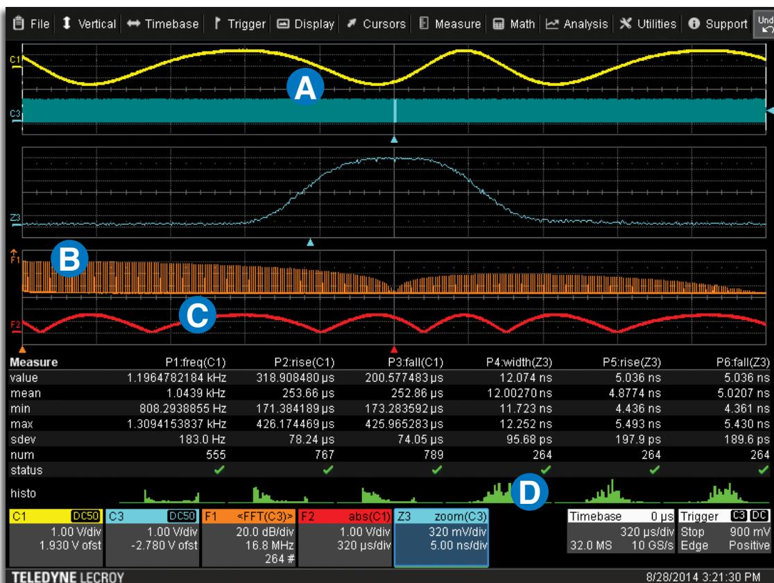
**A** Дискретизация 10 ГГц и 16 МБ на канал позволяют зафиксировать и отобразить сигнал во всех деталях. Установка максимальной частоты дискретизации позволяет захватить детализированный сигнал, без пропуска аномалий, в 4-х канальном режиме работы длительность сигнала с максимальной частотой дискретизации составит 1,6 мс, в 2-х канальном режиме – 3,2 мс.
